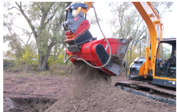
Abbildung 2: Schaufelseparator in Aktion.
